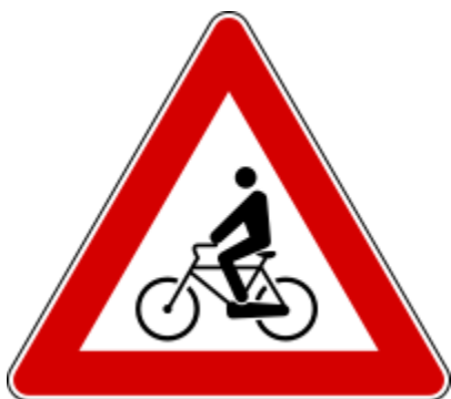
Presegnala un attraversamento ciclabile sulle strade extraurbane e su quelle urbane con limite di velocità superiore a 50 km/h.
